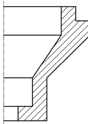
1. Completamos la figura de revolución mediante simetría al eje y omitiendo las partes no vistas interiores.
